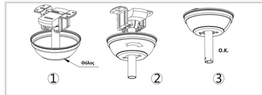
Ανυψώστε τον θόλο στη βάση στερέωσης, ευθυγραμμίζοντας τις χαλαρωμένες βίδες στη βάση στερέωσης με τις οπές στο θόλο. Στρίψτε το θόλο για να ασφαλίσει. Επανατοποθετήστε τις βίδες και ασφαλίστε όλες τις βίδες με κετασαβίδι.
