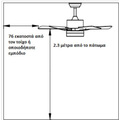
Αυτός ο ανεμιστήρας μπορεί να τοποθετηθεί με κάτω ράβδο σε κανονική ή θολωτή οροφή. Το μήκος ανάρτησης μπορεί να επεκταθεί με μια μεγαλύτερη ράβδο.
