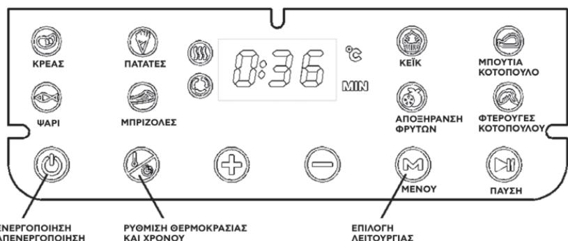
Επιλέξτε θερμοκρασίες τηγανίσματος στον αέρα από 40° έως 200°. Οι θερμοκρασίες μπορούν να ρυθμιστούν ανά πάσα στιγμή με τη χρήση των πλήκτρων και . Αφού ρυθμίστε τη θερμοκρασία λειτουργίας και το χρόνο με τα πλήκτρα και , πατήστε το κουμπί για να ξεκινήσει η λειτουργία της συσκευής. Για να εξασφαλίσετε ομοιόμορφο τηγάνισμα ανοίξτε το συρτάρι στη μέση του χρόνου μαγειρέματος. Ελέγχτε, γυρίστε τα τρόφιμα στο κάδο τηγανίσματος.
